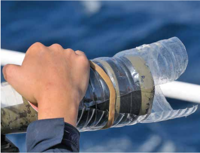
► Een versneden petfles vormt een goedkope lensbescherming voor je telescoop (Foto: Martijn De Jonge)
