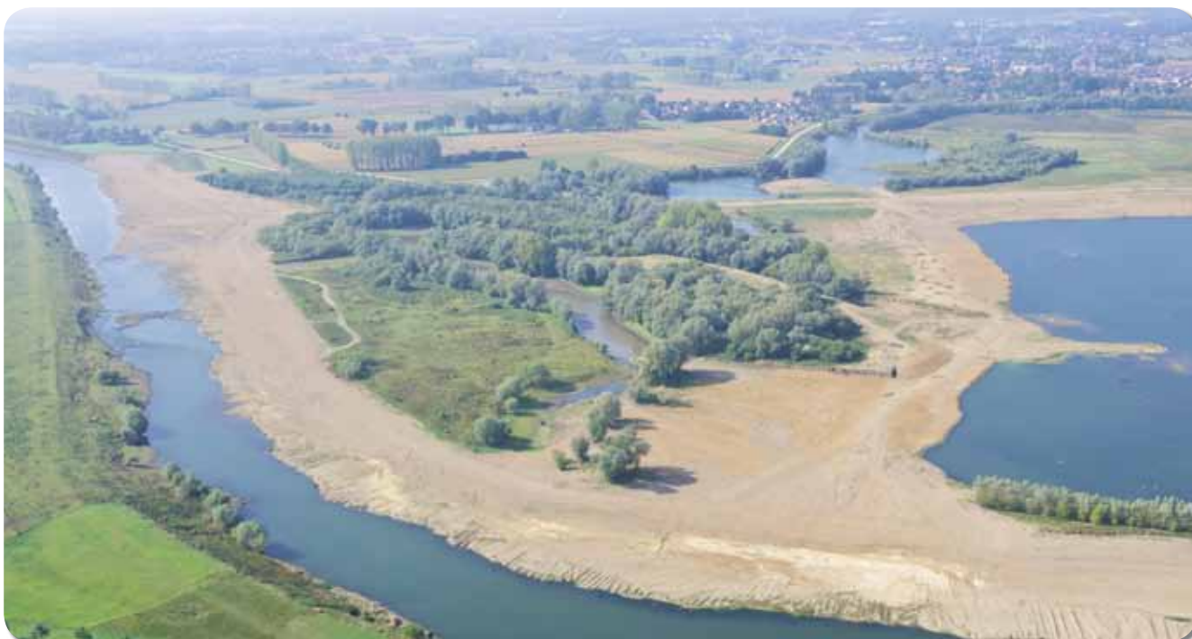
Zicht op de locaties Groeskens en Kerkweerd, respectievelijk in linker- en rechterbovenhoek van de foto gelegen; op de voorgrond de afgegraven oevers, waaruit het substraat afkomstig is. (foto: De Scheepvaart/Rijkswaterstaat-Maaswerken)
