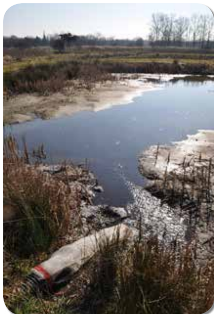
Figuren 4, 5 en 6. Verschillende systemen van visfilters: een inox filterbuis die wordt geplaatst aan de voorkant van de buis met de watertoevoer (Figuur 4), een nylon filterzak die wordt vastgehecht aan de achterkant van de buis (Figuur 5) en het resultaat na één dag gefilterd water ophalen op een vijver: grof organisch materiaal en veel Blauwbandgrondels, Zonnebaarsen en enkele Blankvoorns (Figuur 6). (foto's: Tom Verschraegen)
