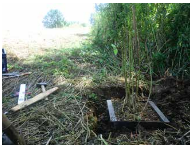
Figuur 3. Bodemstaalname voor het bepalen van de wortellengtedensiteit op een dijk begroeid met brandnetelruigte in Appels Dendermonde. (© Wouter Vannoppen)
