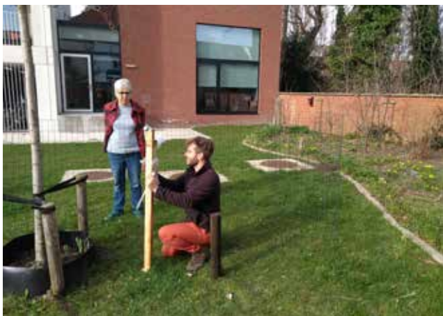
Het plaatsen van een microklimaatstation op een locatie met veel laag groen en enkele jonge boompjes. De low-cost sensoren maten 200 dagen lang de vier weersomstandigheden nodig om onze warmteperceptie te beschrijven: de luchttemperatuur, de luchtvochtigheid, de warmtestraling en de windsnelheid. (© Lieve Van Der Schueren)
