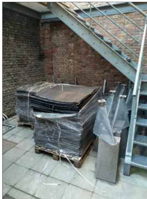
Figuur 2 Links - Voorbeeld van de slangenplaten zoals aangemaakt en gelabeld voor dit project. Het gaat om rubberen matten met een afmeting van 50 x 80 cm met een gemiddelde dikte van 8mm. Foto: Ilf Jacobs Figuur 3 Rechts - Beeld op de grote hoeveelheid slangenplaten die ingezet worden ivk de inhaalslag en het meetnet. Foto: Ilf Jacobs
