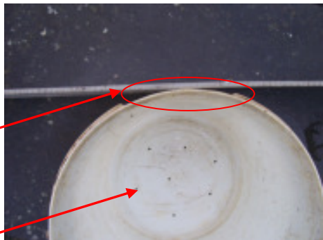
Ronde emmer waarvan een stuk rand recht is afgesneden
