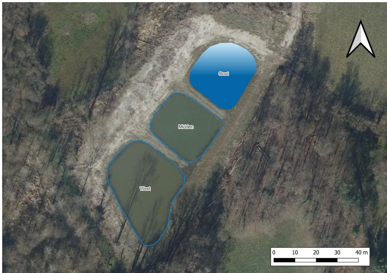
Figuur 6: Voorbeeld van een noord-zuid gradiënt qua waterdiepte voor het meest oostelijke compartiment.
