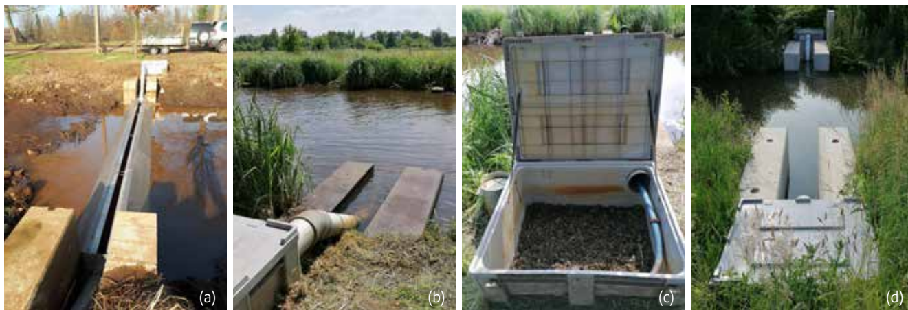
Figuur 2. Het sleufval-containersisteem op de Kleine Nete in Grobbendonk, tijdens plaatsing (a), tijdens de voorjaarsmigratie (b) en bij lediging van de container (c). Het sleufval-containersisteem op de Driesesloot te Wichelen (d). (© INBO)
